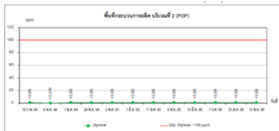
ภาพที่ 4.48 กราฟแสดงผลการตรวจวัด Styrene ในพื้นที่ทำงาน บริเวณ พื้นที่กระบวนการผลิต บริเวณที่ 2 (POP)
